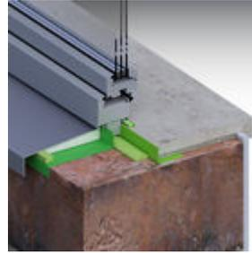
Lösungsmöglichkeit: Innen: ME500 TwinAktiv EW mit SP025 Fensterfolienkleber Öko, Mitte: FM220 PUR-Schaum Basic, Außen: TP600 illmod 600, ME500 TwinAktiv EW mit SP025 Fensterfolienkleber Öko, SP525 Hochbaufugen-Dichtstoff mit PR102 PE-Rundschnur
