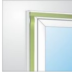
Bild 1: Bandverlegung bei der Fenstermontage
